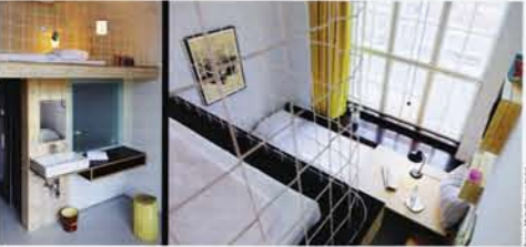
Die Raumhöhe des Altbaus erlaubt das Einfügen einer zweiten Ebene auf der Sanitär-/Schrankbox
